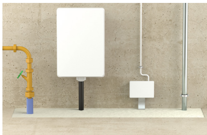
Mix de penetración de servicio
