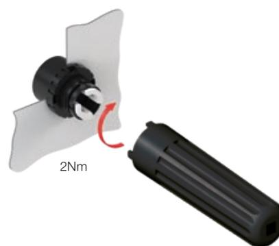
Dar aperto e torque com ferramenta de fixação.
