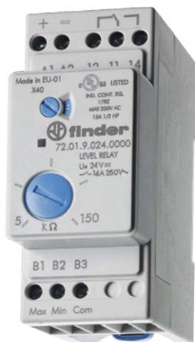
Relé de control de nivel para líquidos conductivos Tipo 72.01 con sensibilidad ajustable (5 ... 150) kΩ, retardo de intervención seleccionable (0.5 so 7 s) por selector y función de llenado o vaciado seleccionable por selector.
