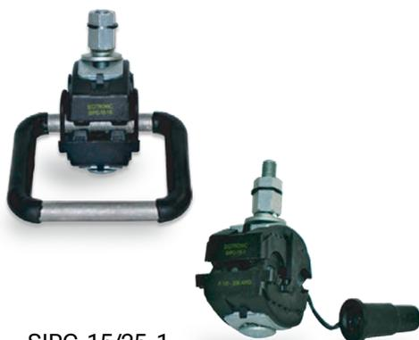
Los conectores de perforación SIPC - 15/25 y SIPC-35 permiten realizar derivaciones en líneas semiaisladas de media tensión hasta 35 kV sin necesidad de seccionar los conductores a derivar ni de retirar el aislamiento de éstos.
