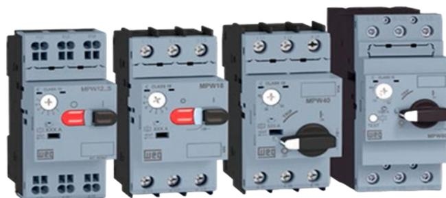
Posee versiones con accionamiento a través de botones (MPW12/18) o por accionamiento rotativo (MPW40/80/100) e indicación de disparo (Trip), permitiendo al operador la visualización del estado del guardamotor. Los guardamotors pueden ser bloqueados con candados o similar en la posición "desconectado", garantizando la seguridad en mantenimientos.
